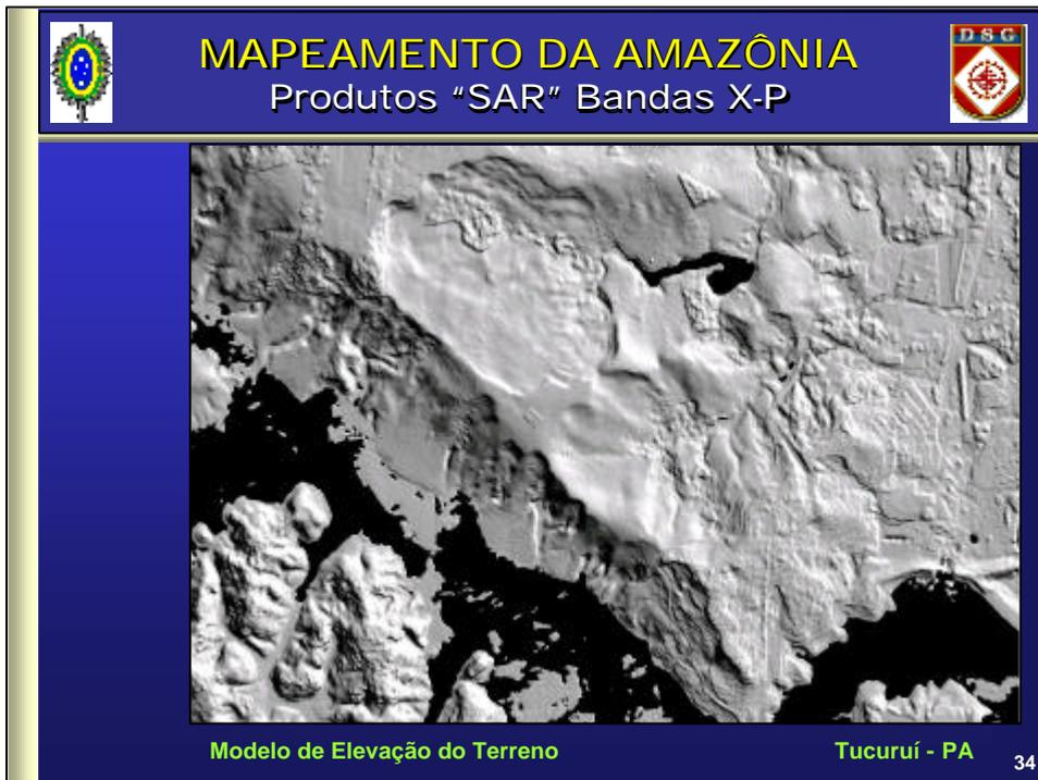
Neste slide temos a vista superior do modelo de elevação do terreno da mesma área de Tucuruí. Observe -se a ausência de cobertura vegetal e edificações, encontradas no modelo de elevação de superfície.
