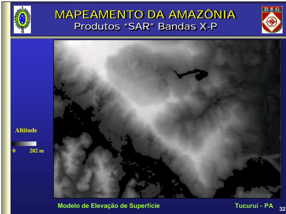
Vemos a mesma vista superior do modelo de elevação de superfície, agora com altitudes dos pontos da superfície representadas segundo uma escala de cinza, correspondente aos seus valores. A parte mais clara é a parte mais alta.
