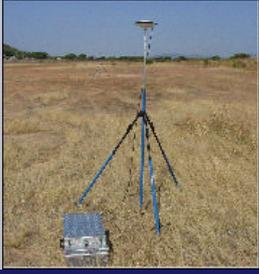
**Estação Base para o Método Diferencial de Posicionamento GPS**
