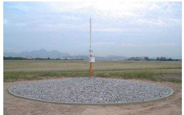
Figura 4 – Antena de uma das estações de referência do GBAS instalada no aeroporto do Galeão no Rio de Janeiro/RJ.
