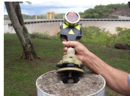
Fig. 2 – Monitoramento geodésico para detecção de deslocamentos horizontais. Fonte: O Autor.
