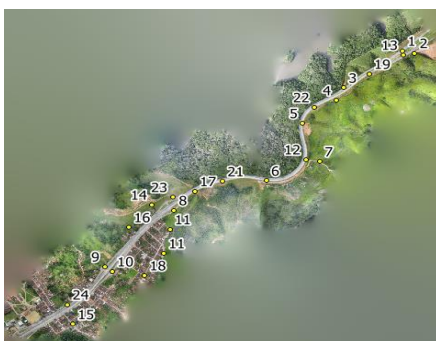
Fig. 2 - Distribuição de Pontos de Apoio sobre o Trecho da Imagem da BR-408
