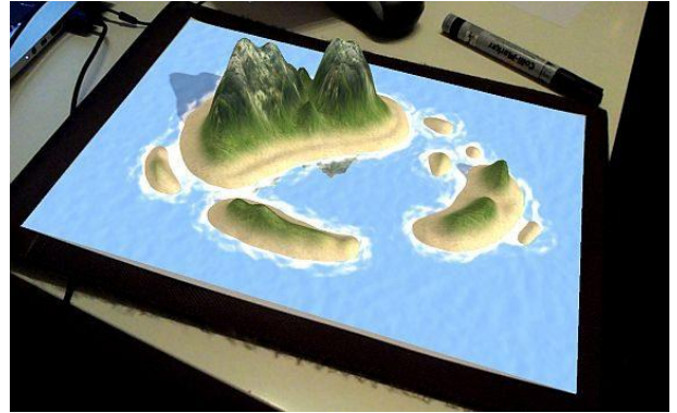
Fig. 3 – LandscapAR, aplicativo de leitura e projeção em Realidade Aumentada de curvas de nível.
