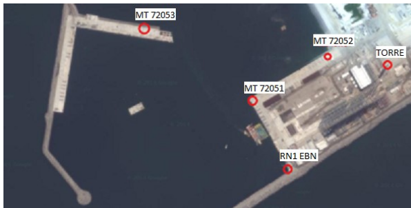
Fig.7 – Marcos testemunhos e ponto de auxílio à navegação instalados na área.
