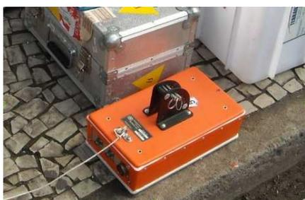
Figura 3: Antena 300MHz do aparelho GEORADAR
