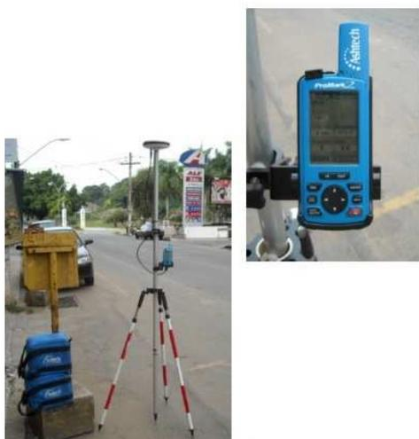
Figura 4: Receptor de sinal GPS.
