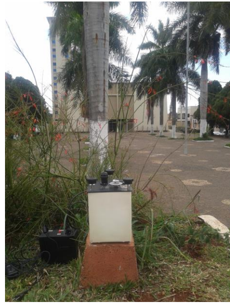
Fig. 4 – Medida gravimétrica sobre marco geodésico
