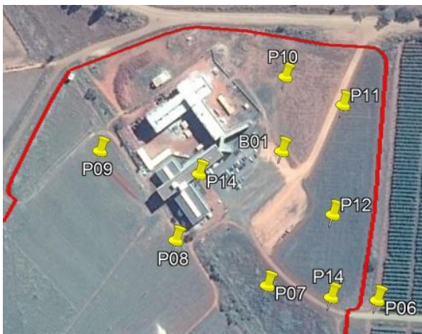
Fig. 3 - Disposição dos pontos de apoio
