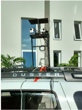
Figura 01 – Sistema de Mapeamento utilizado nos trabalhos de mapeamento móvel na Universidade Federal de Uberlândia.
