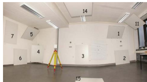
Fig. 2 - Exemplo de alvos para calibração baseada em plano
