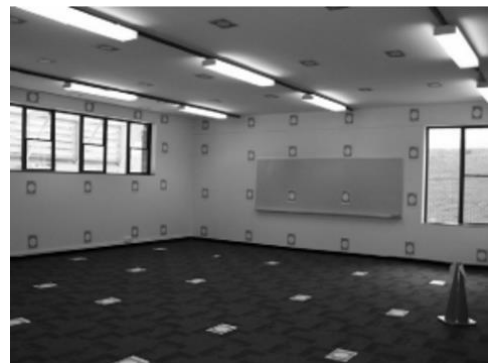
Fig. 1 - Disposição dos alvos de uma calibração ponto a ponto.
