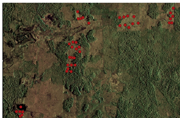
Fig. 6 – Imagem SAR colorida (composição das bandas X e P) após a supressão da vegetação com indicação da localização dos GCPs
