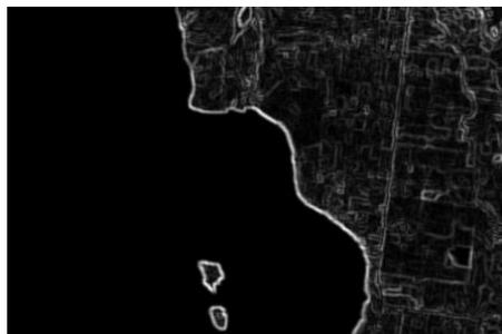
Fig. 7 – Gradiente morfológico da aplicação da função `filter_gauss_adapt()` com uma máscara 5 x 5 sobre a imagem bruta da Fig. 3c.
