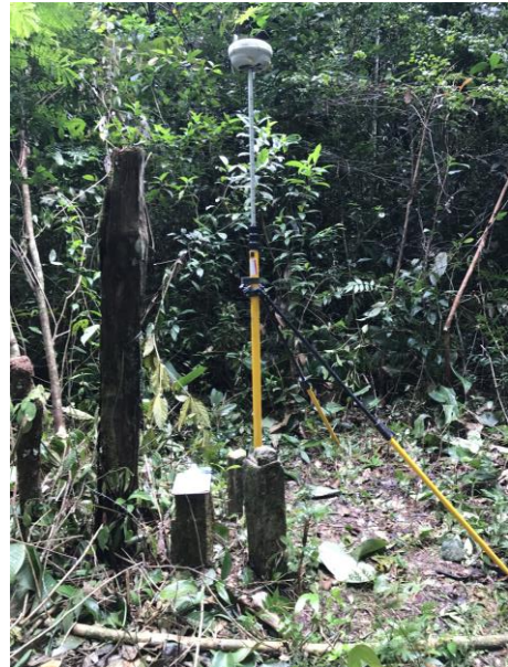
Fig. 03 – Localização do marco e instalação do GPS Geodésico.
