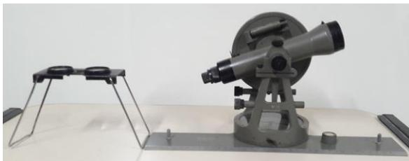
Figura 2: Alidade de prancheta e estereoscópio de bolso da empresa Vasconcellos.
