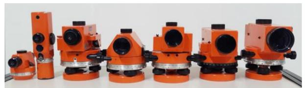
Figura 4: Níveis modelos N40, NA4, SN3, SN3, SNC3, SNA3, SNA2.
