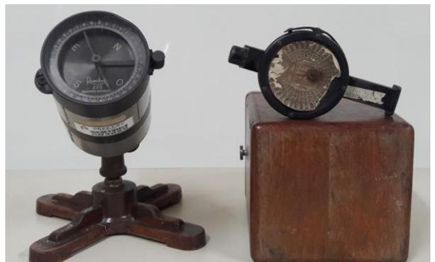
Figura 8 Pantômetro e Clinômetro Rosenhain
