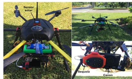
Fig. 2. Hexator Xfly ST 800 e sensores embarcados.
