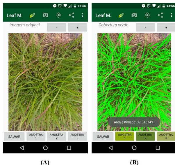
Fig. 4 – Telas de seleção de amostras (A) e de classificação da cobertura foliar verde (B) no aplicativo.
