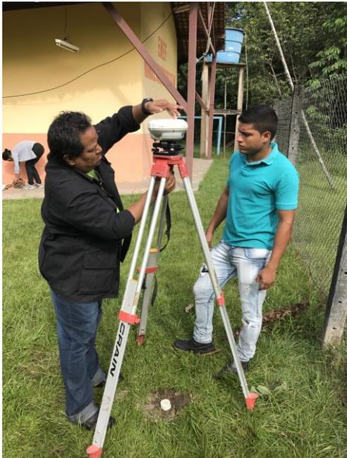
Fig. 02 – Instalação da Base para coleta de dados.
